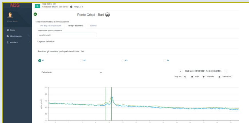
Rappresentazione delle elaborazioni delle misure degli accelerometri: PSD attuale e PSD di riferimento.
